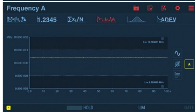
Obrázok 2: Prístroj FTR-210R disponuje integrovanou funkciou nepretržitého porovnávania signálu z prijímača GNSS a vnútorného oscilátora. Frekvenčný posun sa zobrazuje a ukladá, pričom kedykoľvek je možné vygenerovať kalibračný protokol s možnosťou výsledovateľnosti.
